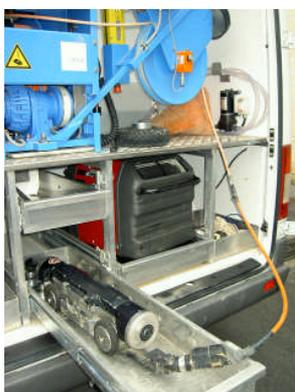
Para la inspección interior del estado de las redes de alcantarillado en Oviedo, periódicamente se emplea un robot con cámara de TV, que es guiada a través del conducto mediante un tractor dirigido remotamente desde el centro de control ubicado en un furgón.
