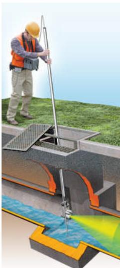
como “robot con cámara de TV” que se introduce por el interior de los conductos y muestran su estado.
